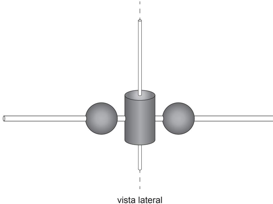
Se aplica una fuerza horizontal de 50 N en perpendicular a la barra, a una distancia de 0,50 m desde el eje central. Se aplica otra fuerza horizontal de 40 N en sentido opuesto, a una distancia de 0,20 m desde el eje central. La resistencia del aire es despreciable.
