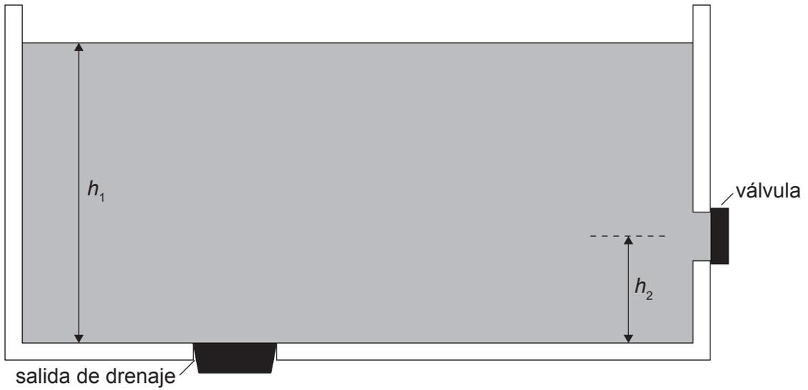
La salida de drenaje tiene un diámetro de 100 mm y se utiliza un tapón metálico con masa de 2,5 kg para cerrar la salida.
