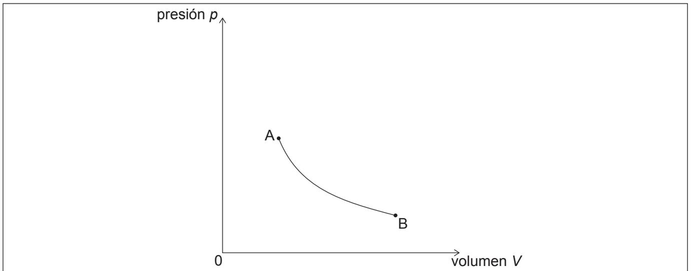
El proceso AB es un cambio isotérmico, como se muestra en el diagrama de presión y volumen ( $pV$ ), en el que el gas se expande hasta tres veces su volumen inicial.
